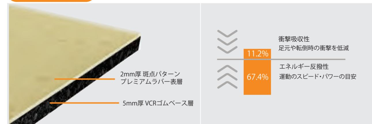
オーロラRxは、病室や居住施設、教育施設の静寂さ、快適さ、安全を必要とするすべてのエリアの要求にマッチするように開発された床材です。表層は、プレミアムラバーシートによってカバーされ、下層の複合加硫ゴム層と積層されることにより、建物に伝わる音や転倒時の怪我のリスクを低減し、足元の快適さと静寂さを約束します。
