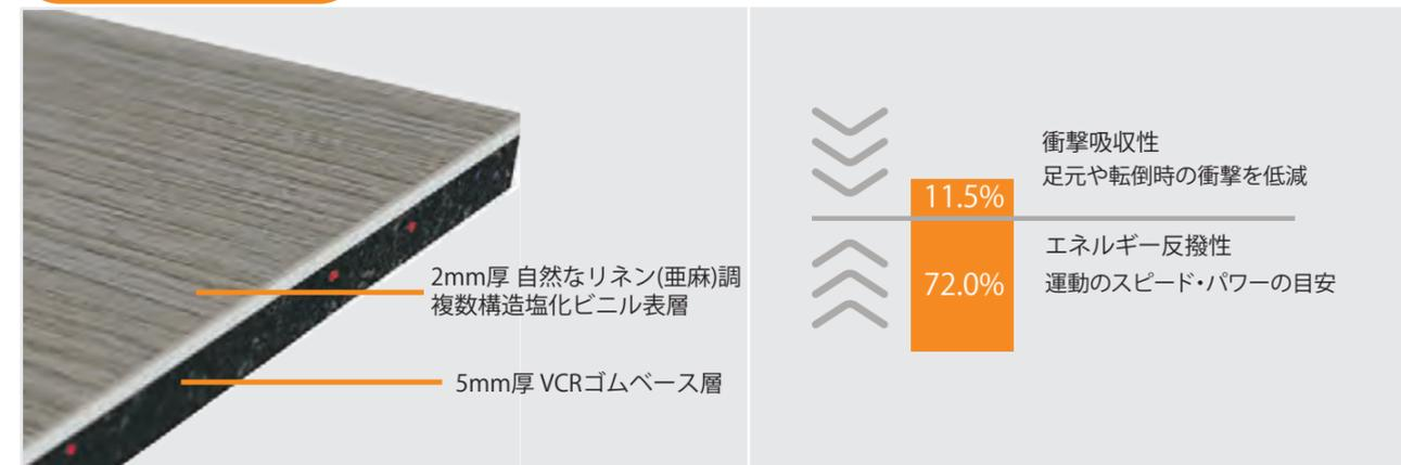
インフィニティRxは、ベージュやブラウン系のやわらかで自然な織物調の伝統的デザインが特徴です。表層トップにはPUR保護層によってカバーされるローメンテナンスな製品です。下層の複合加硫ゴム層は、転倒時の怪我のリスクを低減し、足元の快適さと静寂さを約束します。
