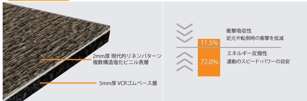
ストレートRxは、医療施設、介護施設、健康管理施設、フィットネス施設や商業施設等の使用頻度の多い過酷な条件下にも耐えるユニークな床材です。表層トップにはPUR保護層によってカバーされるローメンテナンスな製品です。下層の複合加硫ゴム層は、転倒時の怪我のリスクを低減し、足元の快適さと静寂さを約束します。
