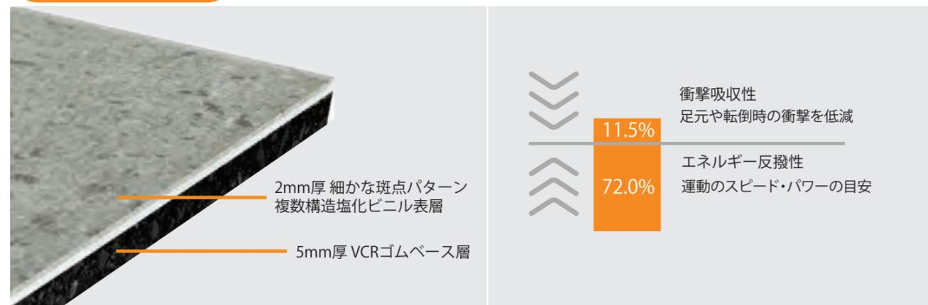
コスモスRxの細かな斑点模様は、部屋の明かりに応じて変化し、伝統的/現代的デザインのインテリアにもマッチするスムーズでナチュラルな床材です。表層トップにはPUR保護層によってカバーされるローメンテナンスな製品です。下層の複合加硫ゴム層は、転倒時の怪我のリスクを低減し、足元の快適さと静寂さを約束します。
