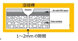
圧力をかけ、溶かした溶接棒を 1~2mm の隙間に押し込むイメージで流し込んでください。
